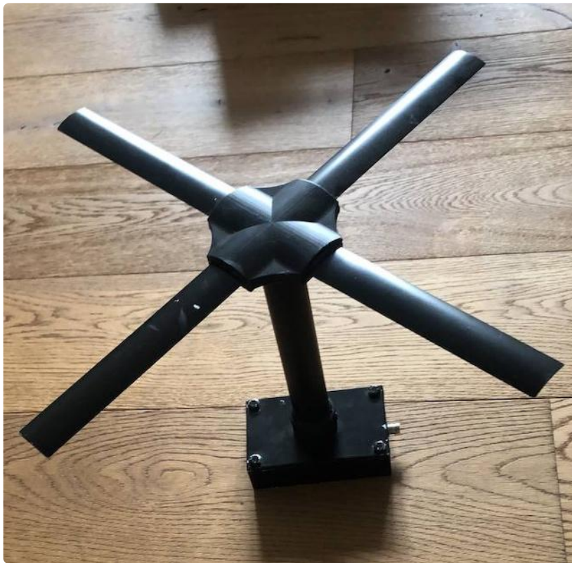
Abbildung 1: Bausatz Modell 1 mit Grundplatte, Gehäuse mit Sockel, Ø32 mm Rohr und Kopf (head_v2) mit Strahlern aus Aluminiumleisten.
